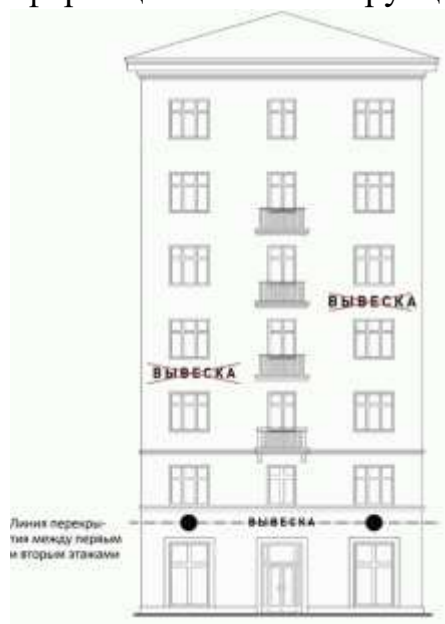
Рисунок 12. Нарушение требований к местам размещения информационных конструкций.
