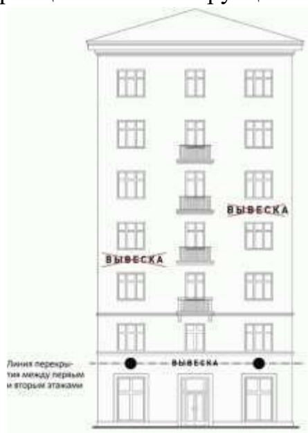
Рисунок 12. Нарушение требований к местам размещения информационных конструкций.
